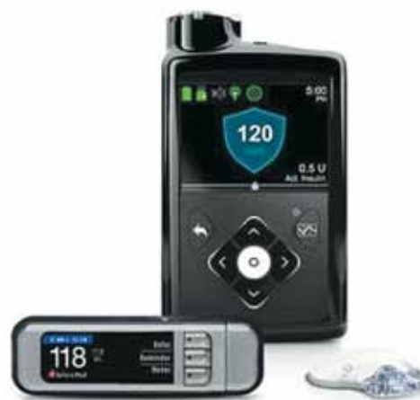
Obrázok 4 – Inzulínová pumpa so zabudovaným CGM - inzulínová pumpa dávkuje inzulín podľa hodnôt získaných z CGM.
